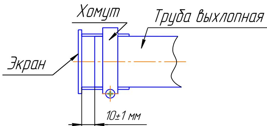
Рис. 7.4 – Установка экрана на выхлопную трубу
