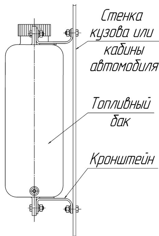
Рис. 7.5 - Установка топливного бака на автомобиль.
