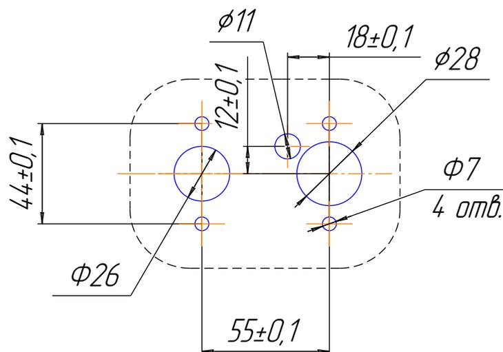
Рис. 7.2 – Монтажные отверстия для установки нагревателя
