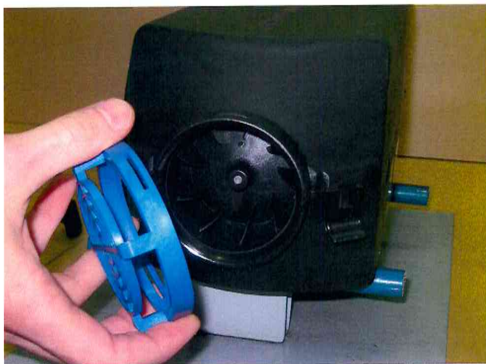
Рисунок 9 Демонтаж защитной решетки
