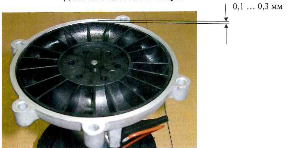
Рисунок 22 Демонтаж нагнетателя воздуха
