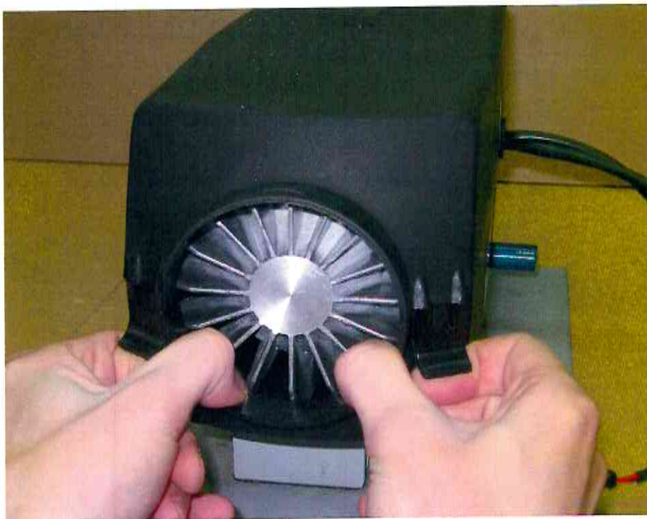
Рисунок 10 Вывод из зацепления защелок со стороны теплообменника
