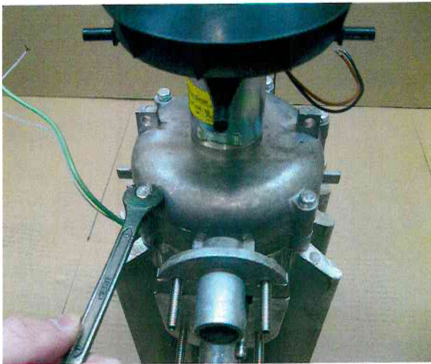
Рисунок 22 Демонтаж нагнетателя воздуха
