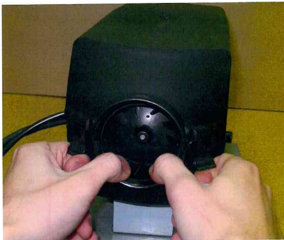
Рисунок 11 Вывод из зацепления защелок со стороны колеса центробежного
